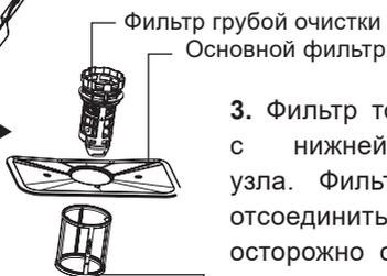
3. Фильтр тонкой очистки можно снять с нижней части фильтрующего узла. Фильтр грубой очистки можно отсоединить от основного фильтра, осторожно сжимая выступы в верхней части и оттягивая его.
