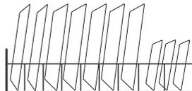
Сервировочную посуду и крышки предпочтительно размещать сбоку стоек, чтобы избежать блокирования вращения верхнего распылительного рычага.
