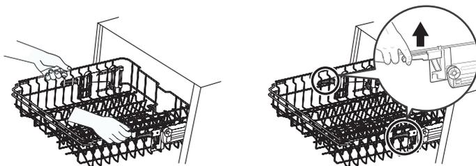
Чтобы поднять верхнюю корзину, просто поднимите верхнюю корзину по центру с каждой стороны, пока корзина не зафиксируется в верхнем положении. Нет необходимости поднимать ручку регулировки.
