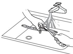
3. Вымойте держатели оросителей в мыльной и теплой воде и используйте мягкую щетку для очистки форсунок. Замените их после тщательной промывки.
